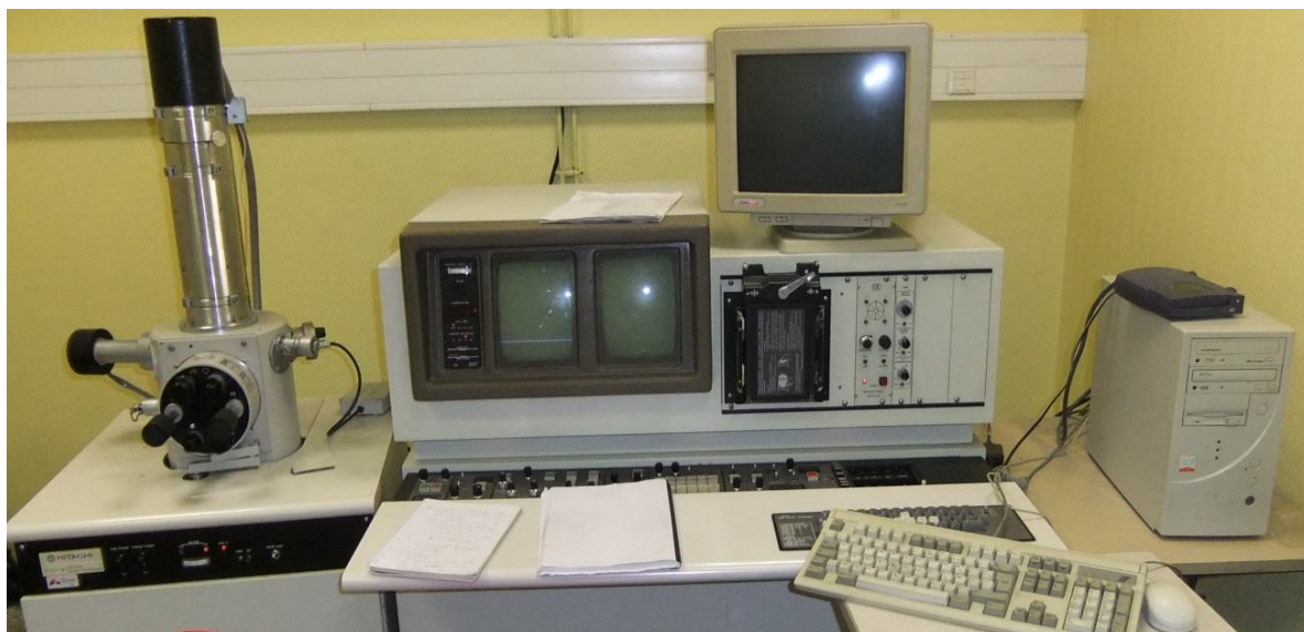
Figure II-4 : MEB de marque HITACHI S-520 au MSMP Arts et Métiers ParisTech Lille.
