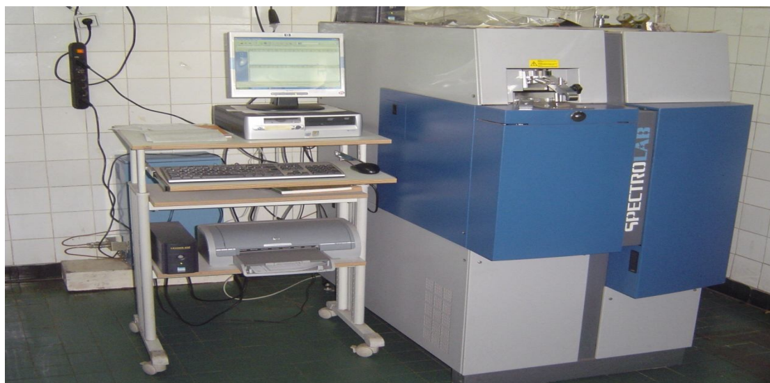
Figure II-2 : Spectromètre SPECTROLAB utilisé pour l'analyse chimique.
