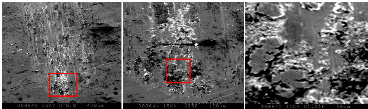
Figure V-40 : Croissance des particules détachées et oxydées croissent formant une fine poudre.
