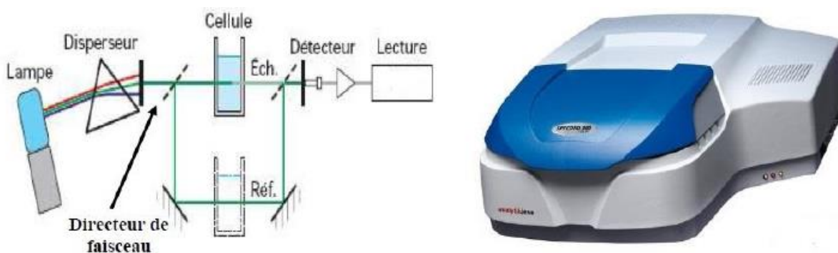
Figure AN.4. Diagramme optique d'un spectrophotomètre (SPECORP 200 plus).
