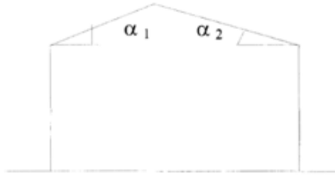
Figure 3 : Coefficient de forme - Toitures à deux versants
