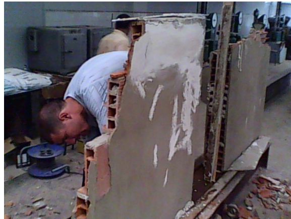
Fig. IV.75 Rupture mur de l'essai n°4 face arrière jauge.
