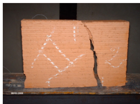
Fig. III.34 mode de rupture des briques en 12 trous pour l'essai de flexion, Les demi-prismes de l'unité obtenus après rupture en flexion Seront rompus en compression.
