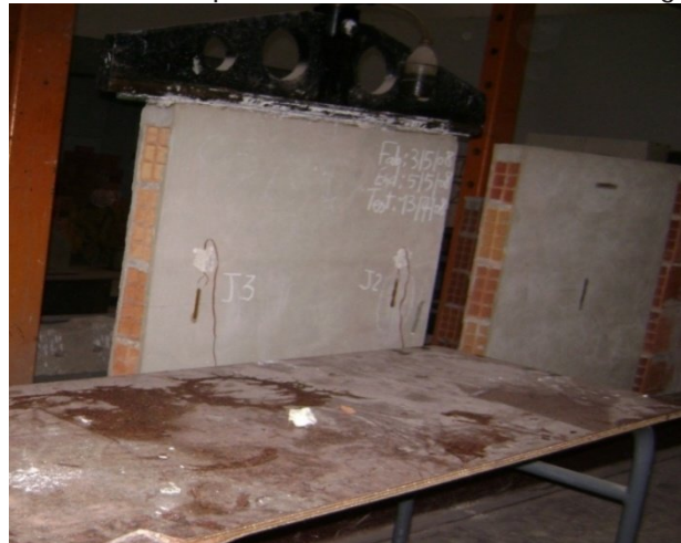
Fig. IV.78 Emplacement des jauges pour l'essai n°5. Fig. IV.79 Préparation des murs pour les essais n°5 et 6.
