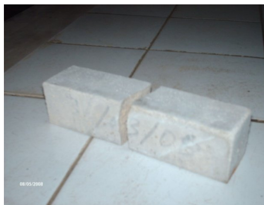
Fig. III.13 : rupture d'une éprouvette en flexion
