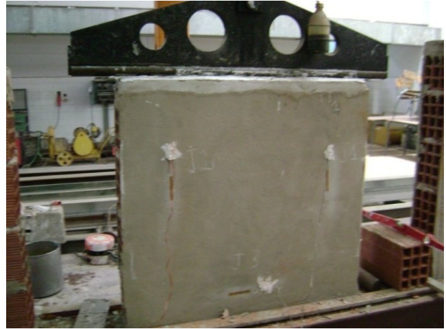
Fig. IV.114. Photo emplacement des jauges d'essai n°16.
