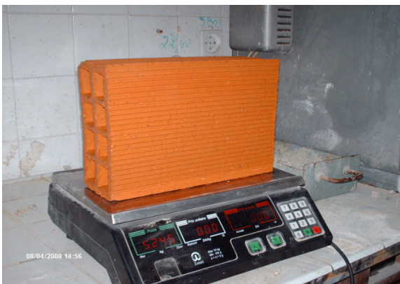
Fig. III.27 Pesée des briques 8 trous après immersion Dans l'eau. M_2 .
