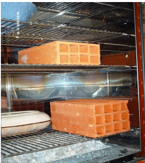
Fig. III.25 séchage des briques 8 et 12 trous jusqu'à Une masse constante. M_1 .
