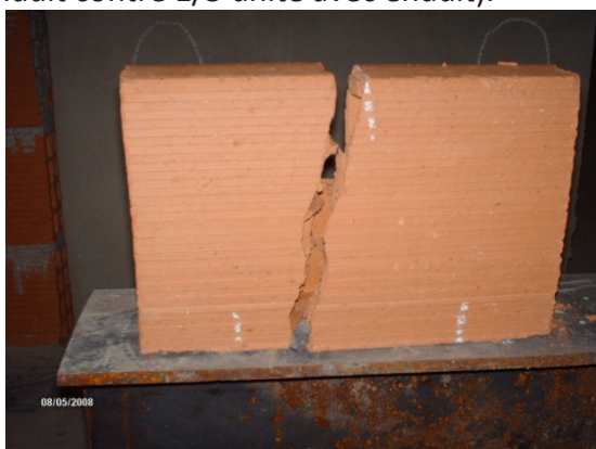
Fig. III.33 mode de rupture des briques en 8 trous pour l'essai de flexion, Les demi-prismes de l'unité obtenus après rupture en flexion Seront rompus en compression.
