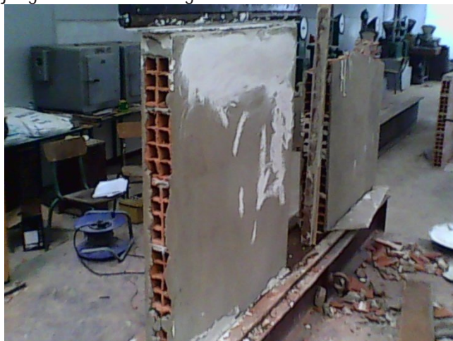
Fig. IV.73 Mur 8 trous avec enduit pour l'essai n°4 face arrière jauge.
