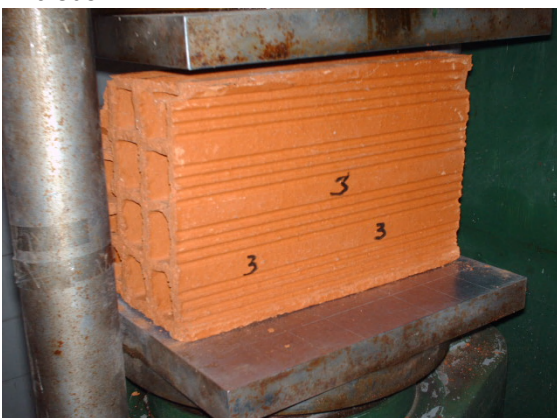
Fig. III.45 Compression d'une éprouvette de brique en 12 trous n°12-3.
