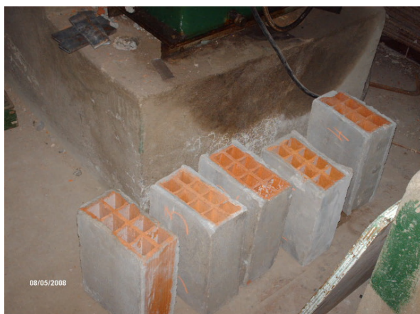
Fig. III.31 Les éprouvettes du brique 8 trous avec l’enduit de ciment.
