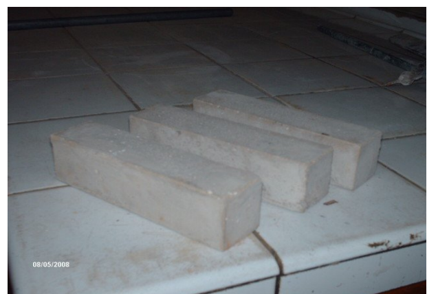
Figure. III.4 Moule pour éprouvettes prismatiques (4x4x16). Figure. III.5 Les éprouvettes prismatiques (4x4x16).
