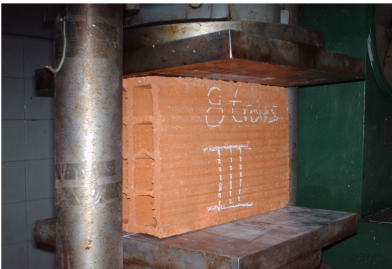
Fig. III.41 Compression d'une éprouvette de brique en 8 trous n°8-3.
