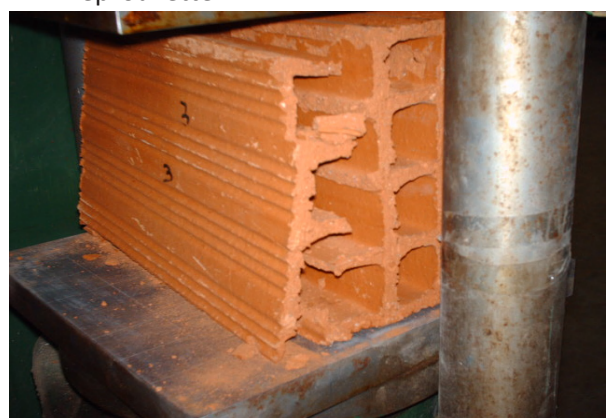
Fig. III.46 Mode de rupture en compression de L'éprouvette n°12-3.
