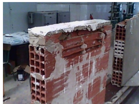
Fig. IV.104. Photo de mur essai n°10 après rupture.
