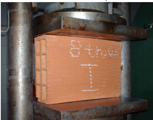
Fig. III.37 Compression d'une éprouvette de brique en 8 trous n°8-1.
