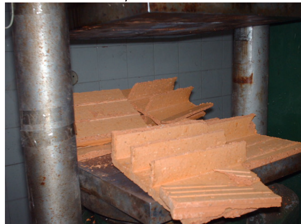
Fig. III.38 Mode de rupture en compression de l'éprouvette n°8-1.
