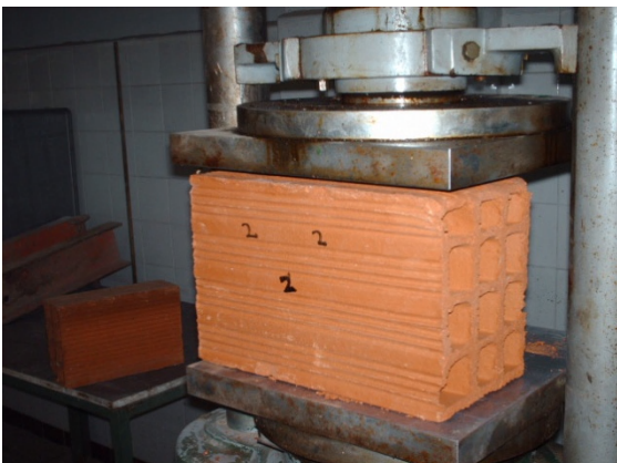
Fig. III.43 Compression d'une éprouvette de brique en 12 trous n°12-1.
