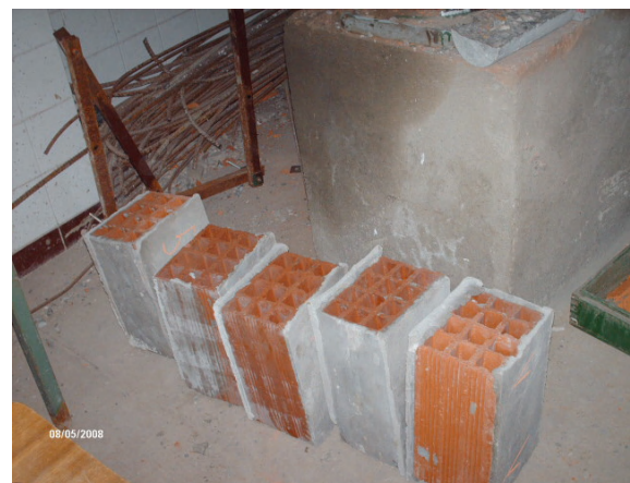
Fig. III.32 Les éprouvettes du brique 12 trous avec l’enduit de ciment.
