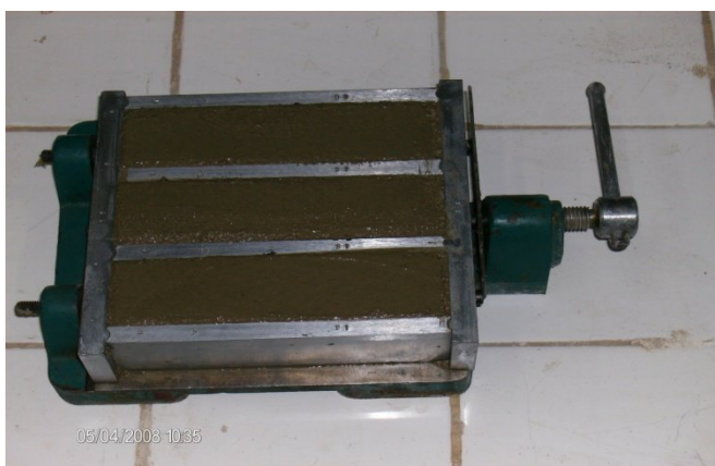
Figure. III.4 Moule pour éprouvettes prismatiques (4x4x16). Figure. III.5 Les éprouvettes prismatiques (4x4x16).
