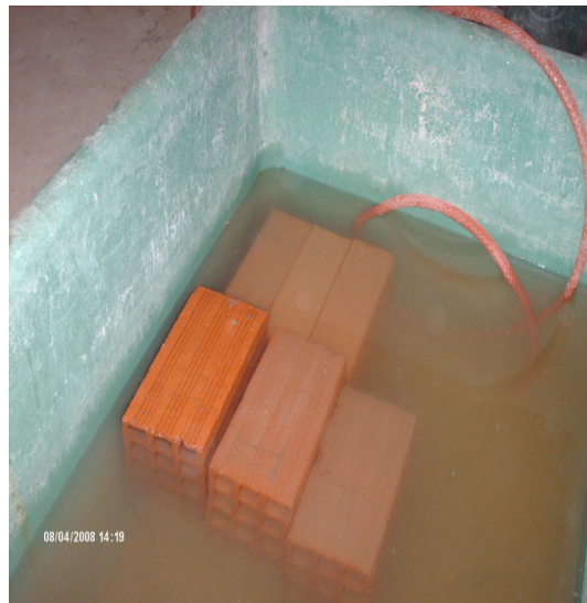
Fig. III.26 Immersion des briques 8 et 12 trous dans l'eau pendant 24 heures.
