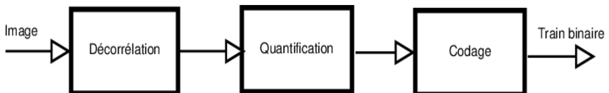
Figure 2.4 : Architecture typique d'une compression d'image à la base de transformée
