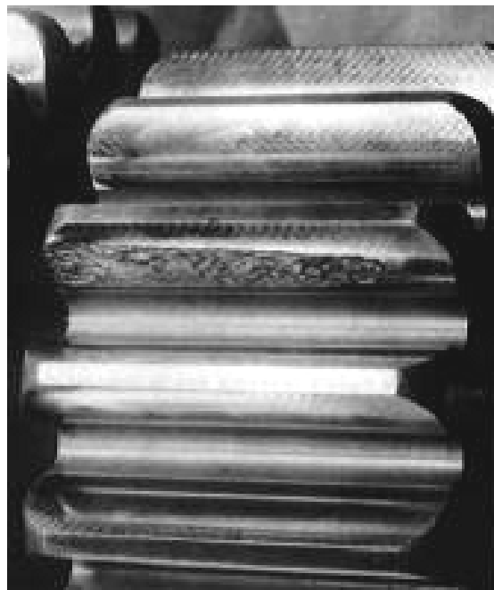
Fig. 19 Pignon totalement écaillé [63]
