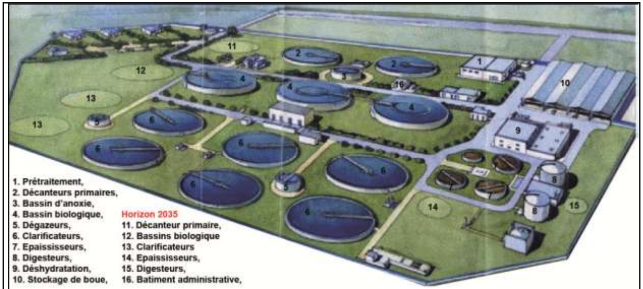
Figure 4.2 : Situation des ouvrages de la STEP d'Annaba
