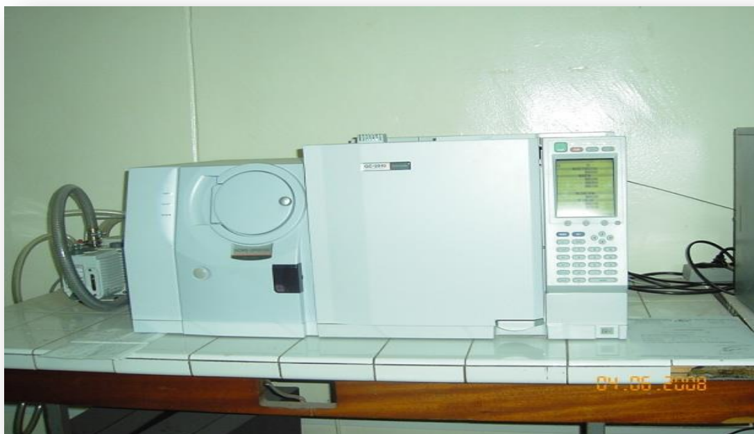
Figure 11: Appareil de chromatographie en Phase Gazeuse couplée a la spectrophotométrie de masse (Photo : Moussaoui, 2011).
