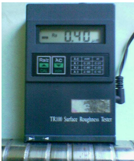
Figure 4.3 Mesure de la rugosité Ra
