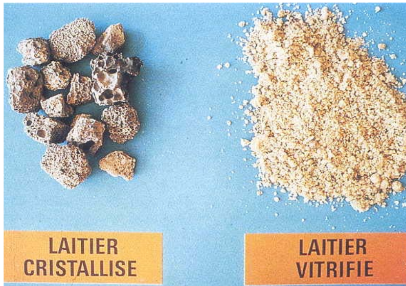
Figure 2 – Laitier cristallisé et laitier vitrifié granulé de haut fourneau
