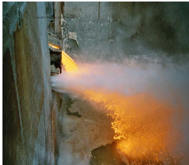
Figure 4 – Granulation et trempe du laitier à sa sortie du haut fourneau d'EL HADJAR
