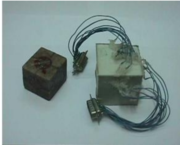
Figure. 4.11 : Montage des jauges et du système d'étanchéité
