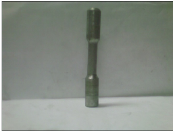
Fig.24. Éprouvette de traction normalisée en alliage AS10
