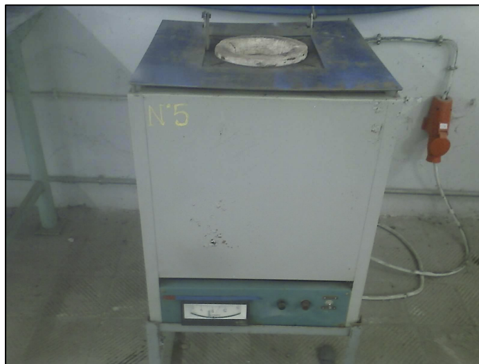
Fig.17. Four électrique à résistance (Four de fusion)
