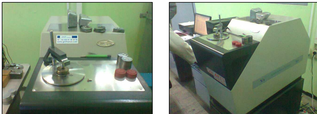
Fig.23. Analyse chimique par la fluorescence X. (ETRAG Constantine)
