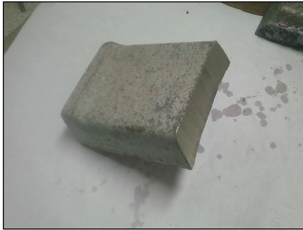
Fig.31. Magnésium pur (99,9%) sous forme de plaquettes
