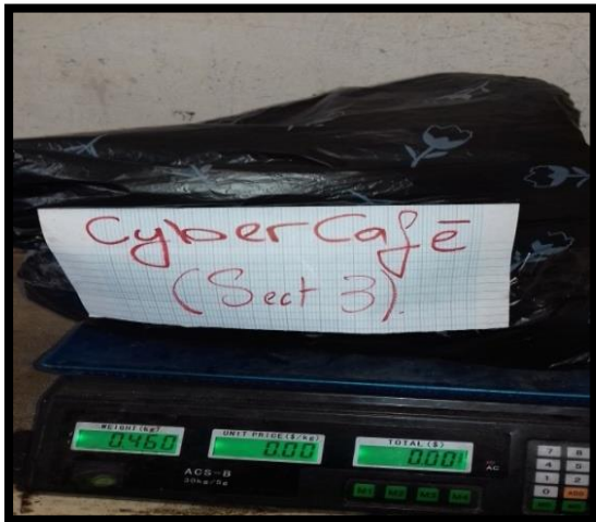
Figure 35: La pesée des déchets avec une balance électronique (max : 30Kg/min : 5g)
