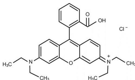
Figure I-4 : Structure moléculaire de Rhodamine B [24]
