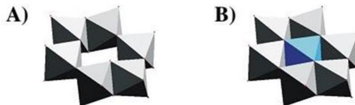
Figure I.14 : A) Couronne de type Anderson. B) Composé de type Anderson possédant un atome central.
