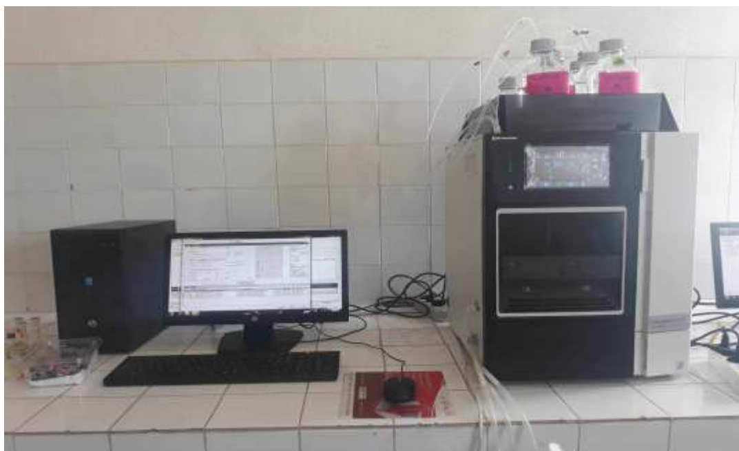
Figure15 : Appareil HPLC ; Prominence- i LC-2030C. (AMIRAT Sabrina,2022).
