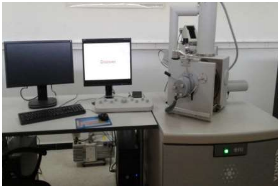
Figure12 : Microscope Electronique à Balayage FEI de type Quanta 250 piloté par le logiciel ZEISS
