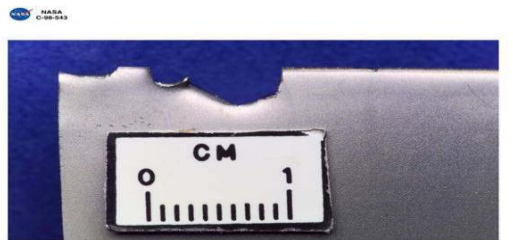
Figure 2.9. Endommagement d'une aube lié au pompage (Stein).
