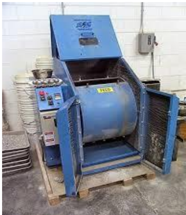
Figure 53 : Appareil Los Angeles (Laboratoire de Travaux Public de l'Est Annaba)
