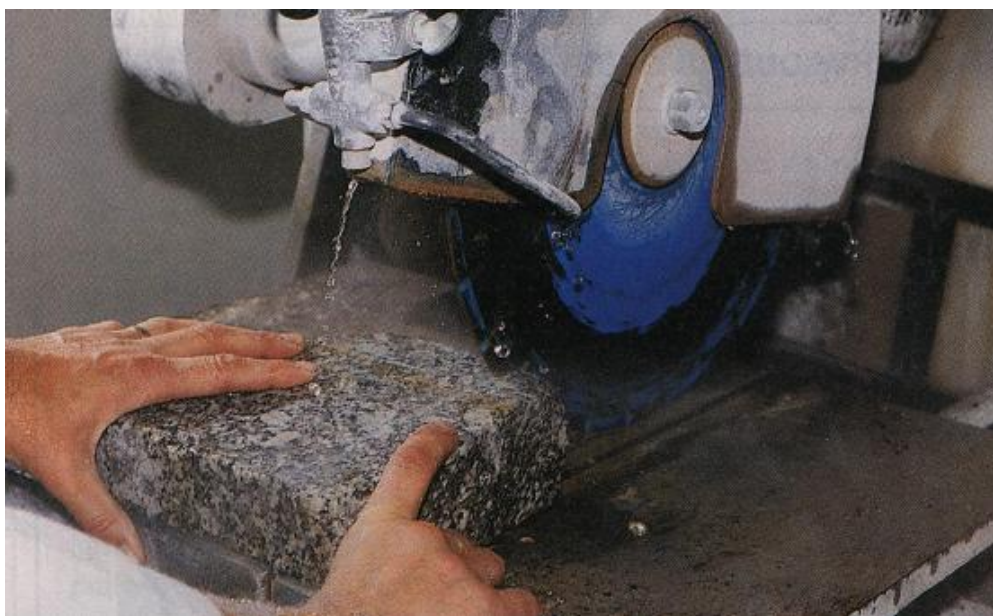
Figure 44 : Sciage de la roche ( les minéraux.free.fr )
