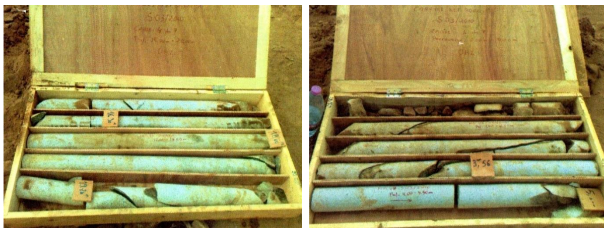
Figure 42 : Prélèvement des échantillons par carottage (OHL-Infrarail 2007)
