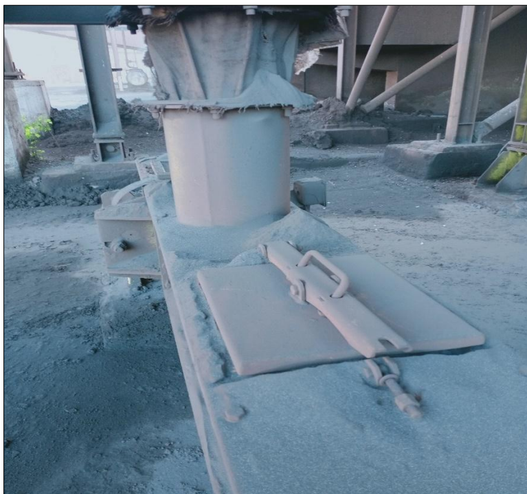
Figure III.16 : Image d'impact de la poussière sur les transporteurs métalliques
