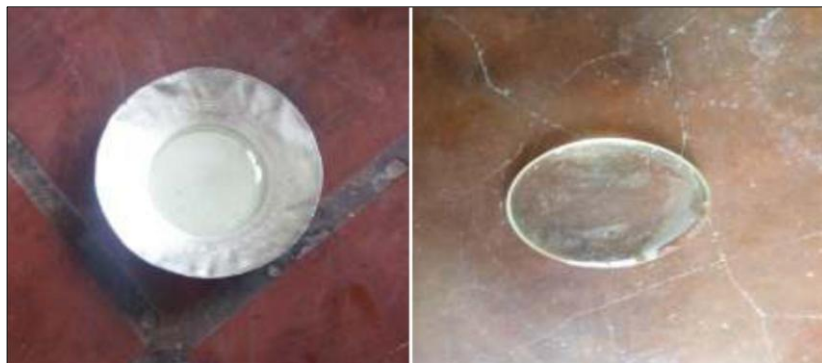
Figure IV.7 : Creuset en platine contenant l'échantillon.
