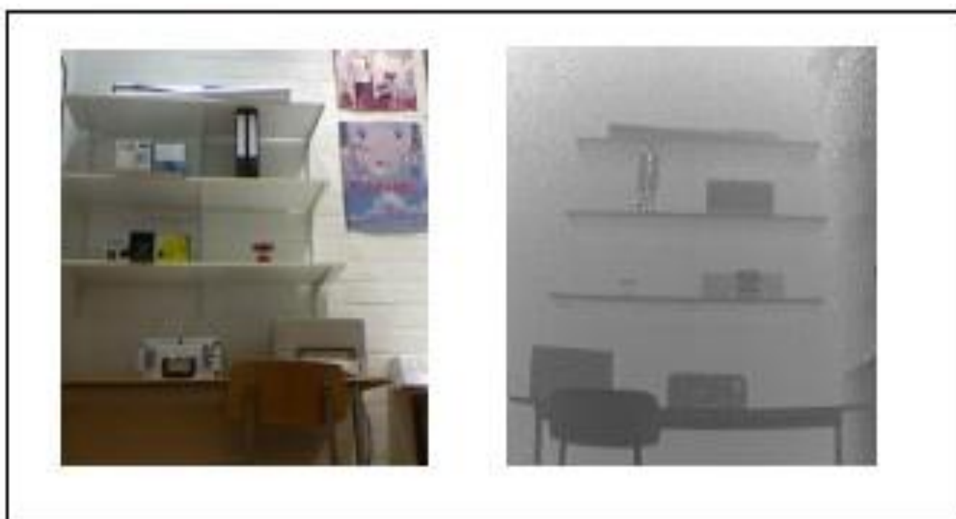
Figure 2.11 – Système d'acquisition d'images de profondeur Cam Cube, à gauche l'image réelle, à droite l'image de profondeur acquise par Cam Cube
