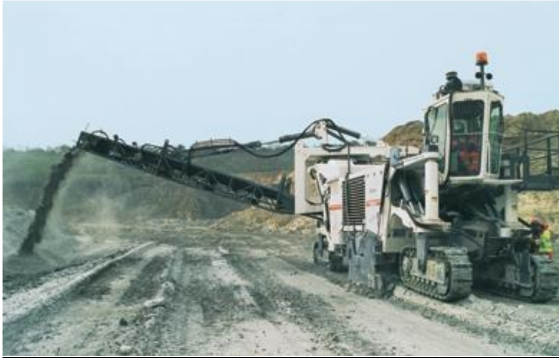
Fig.3.14. Chargement indirect (Déversement latéral)
