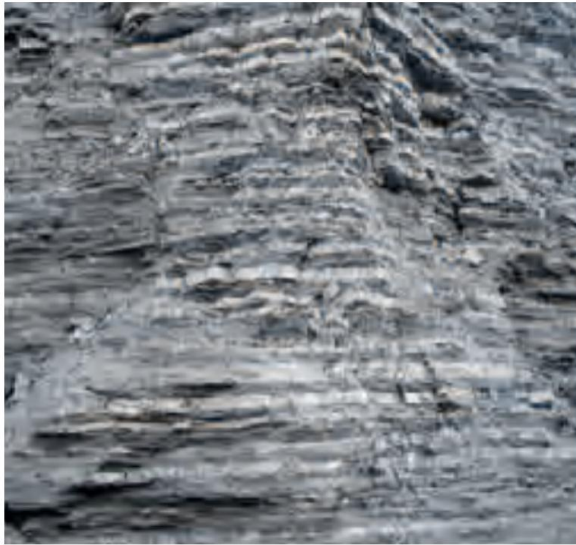
Fig.1.13. Matériau présentant une stratification horizontale ou légèrement inclinée ( <10^\circ ) et une distance de fracturation <15\text{cm}
