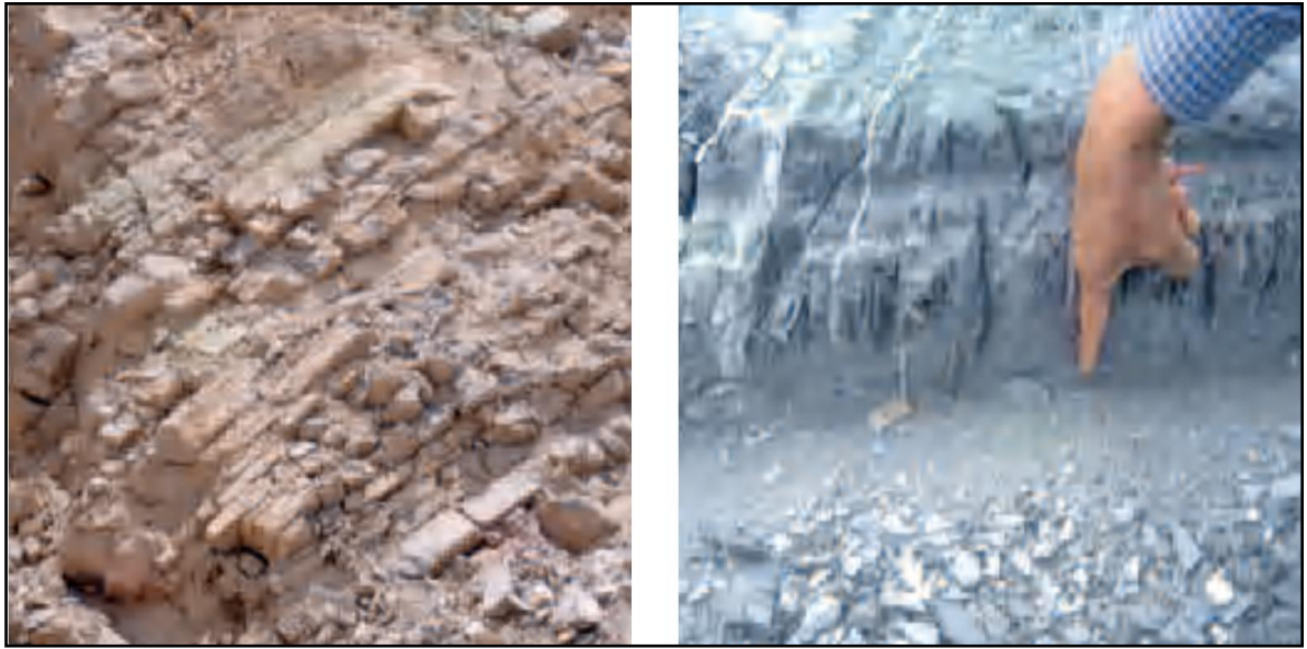
Fig.1.11. Roche stratifiée présentant une direction des fracturations > 15 < 90
