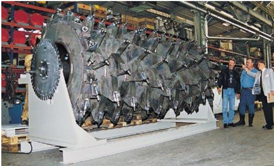
Fig.3.5. Vue du tambour de la machine 2500 SM
