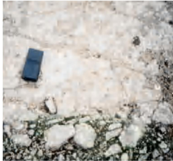
Fig.1.14. Fracturation tridimensionnelle et une distance de une fracturation <15\text{ cm}
