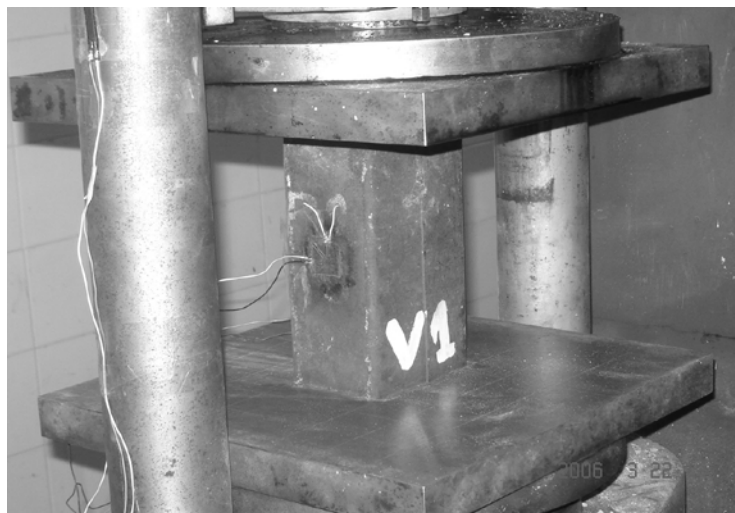
Fig 8.24 : Eprouvette V1 centré dans la presse de compression
