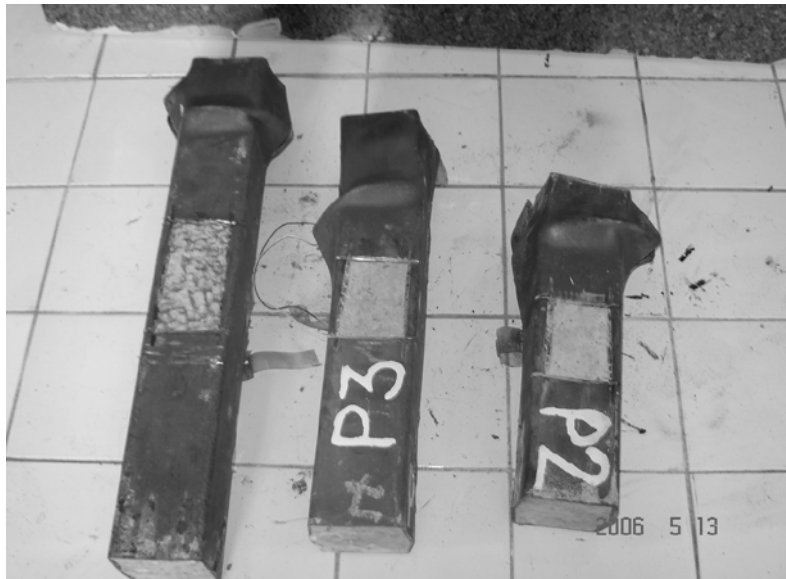
Fig 8.21 : Etat du béton loger dans les éprouvettes pleines P2, P3, P4
