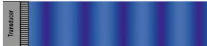
Fig 48 (a): Propagation longitudinale des ondes acoustiques, avec des zones de compression (bandes denses) et des zones de raréfaction (bandes claires) (227)
