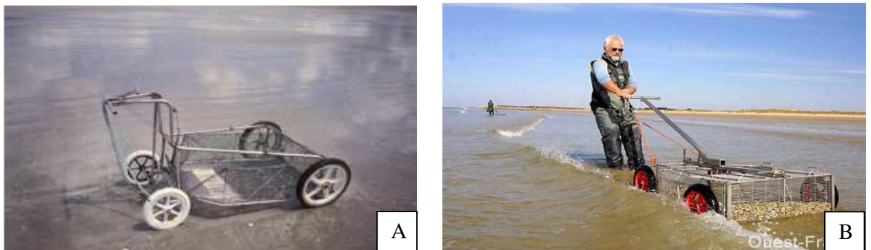
Figure 9. Drague à telline réservée à la pêche professionnelle (A), drague professionnelle en condition de pêche (B).
