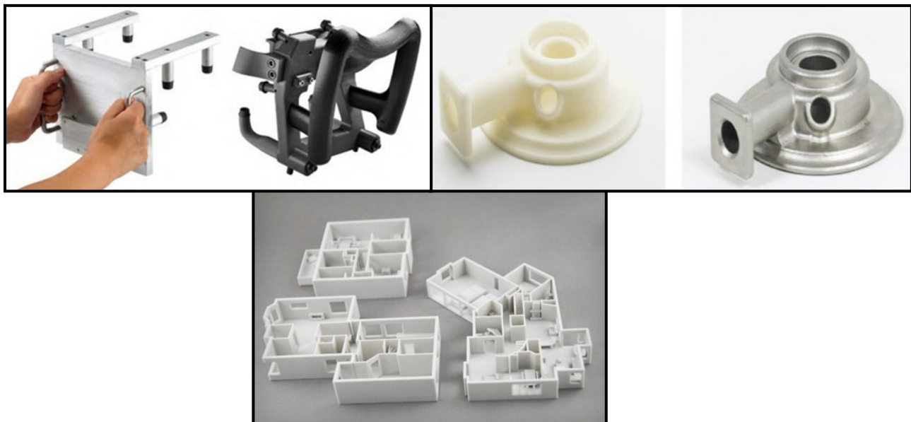
Figure 14. Top Left « Printing of Jigs And Fixture », Top Right « printed cast pattern and final metal investment cast », Bottom « House architecture Prototype »
