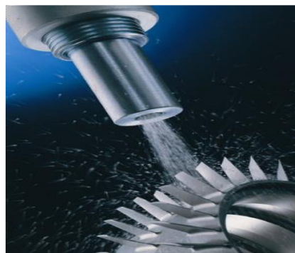
Figure I. 31: Exemple d'une buse de grenailleuse à air comprimé.
