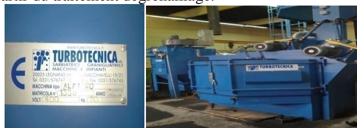
Figure II. 13: installation de grenailage précontrainte au niveau de l'ETRAG "Constantine "
