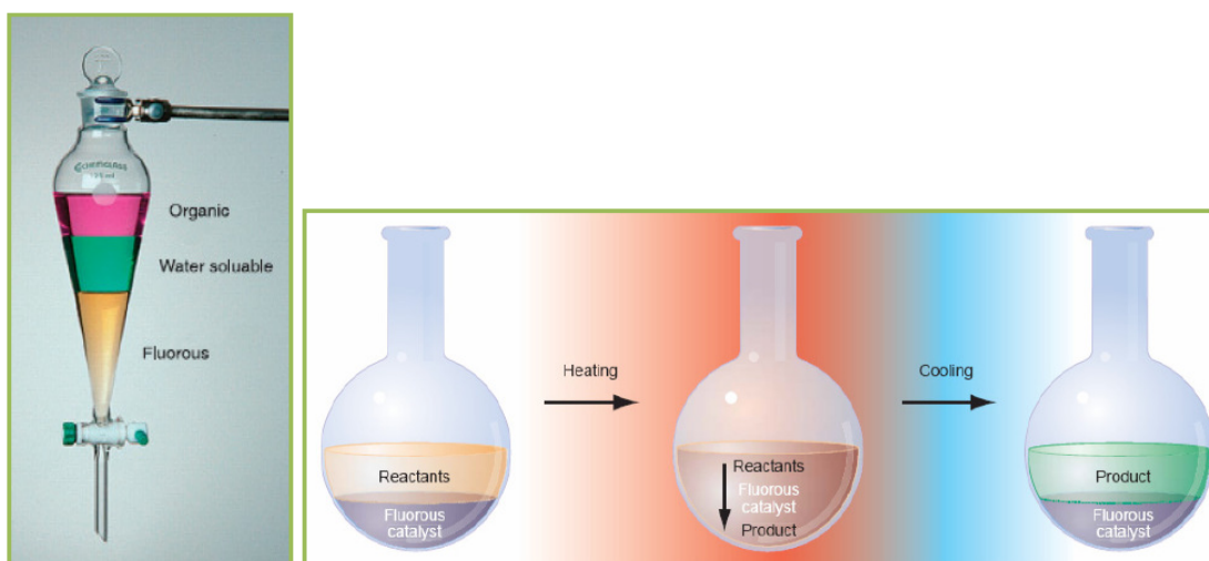
Figure 22: Démonstration de l’utilisation des composés perfluorés comme solvant et comme catalyseurs.
