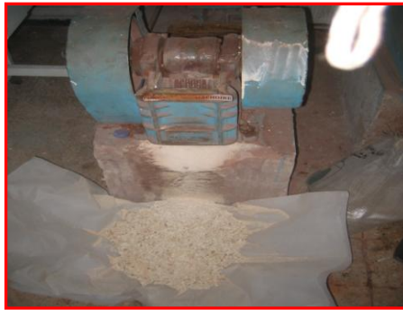
Figure 18. Opération de concassage.
