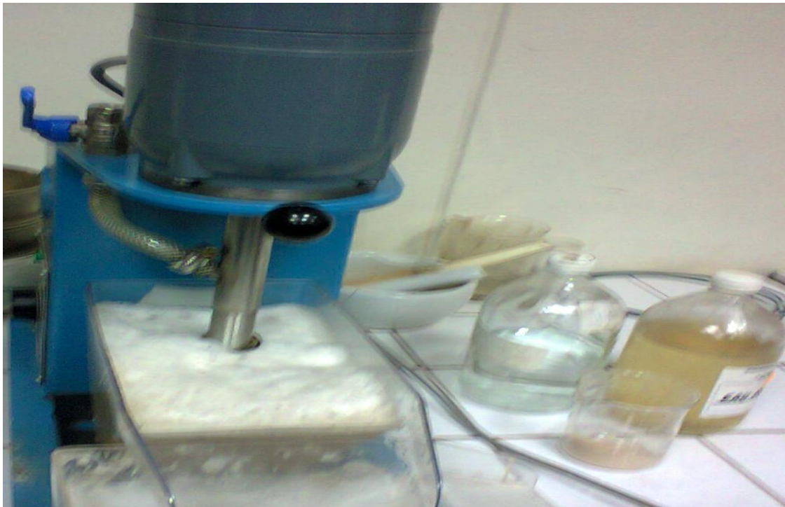
Figure IV. Cellule de laboratoire utilisé pour les essais d'enrichissements
