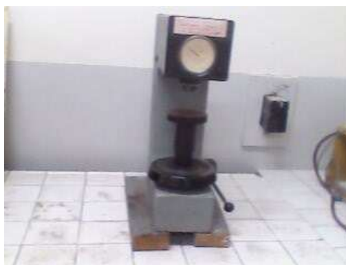
Figure 74. Machine utilisée pour l'essai de dureté HRC
