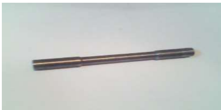
Figure 77. Eprouvette de traction utilisé
