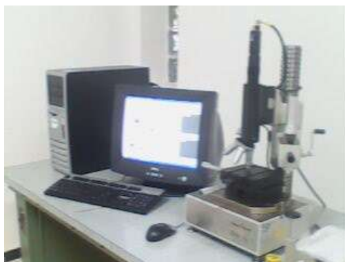
Figure 73. Microduremètre utilisé pour les essais
