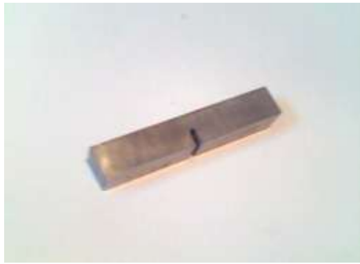
Figure 81. Eprouvette de résilience utilisée
