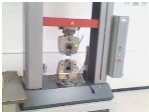
Figure 78. Machine utilisée pour les essais de traction
