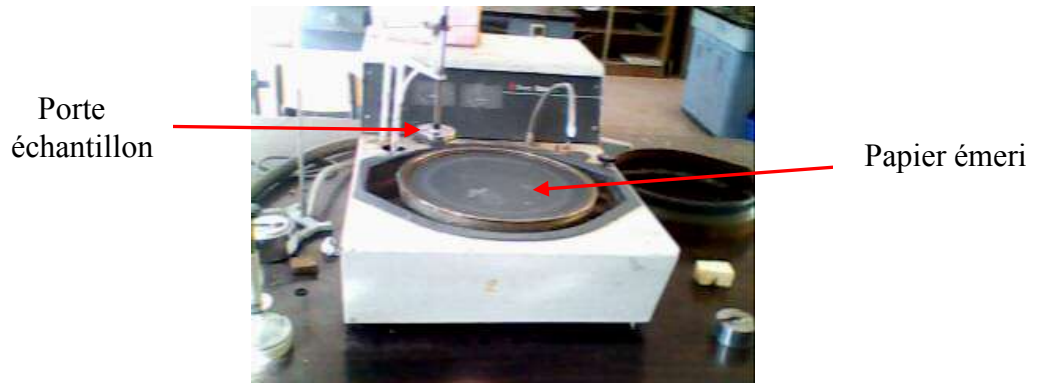
Figure 85. Dispositif utilisé pour l'usure
