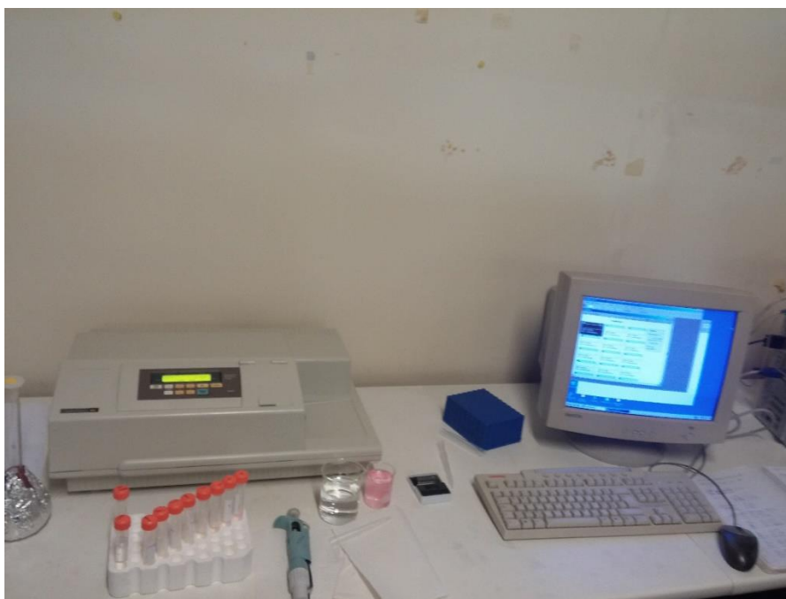
Figure 68. Lecture des concentrations de microplastiques par spectrofluorimétrie Spectramax® M2, USA). (Photo personnelle, 2016)
