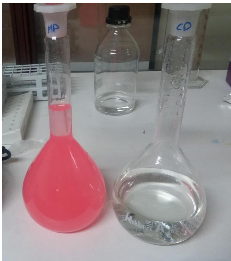
Figure 67. Solutions mères de microplastique et de cadmium préparées. ( Photo personnelle, 2016 )
