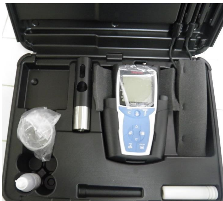
Figure 43. Présentation du multi-paramètre (Thermo Scientific Orion Star Meter ; 5 Star). (Photo personnelle ,2015)
