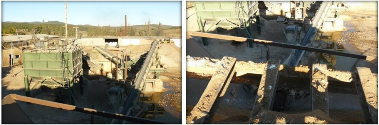
Fig.II.1: Concasseur primaire (concasseeur à mâchoires ENOF 2016). De marque BERGEAUT (VB57)
