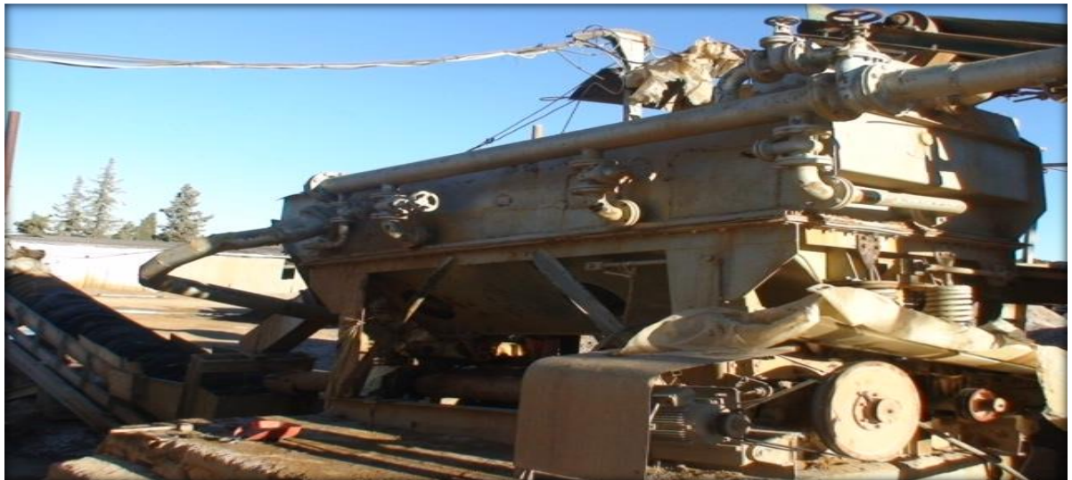
Fig.II.6: Le jig WEMCO d'Ain Mimoun
