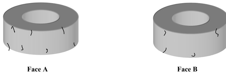
FigureV-7-7 : Représentation du réseau de fissures au 50 ième jour de l'essai de retrait empêché pour la composition pour la composition BAPFMS8
