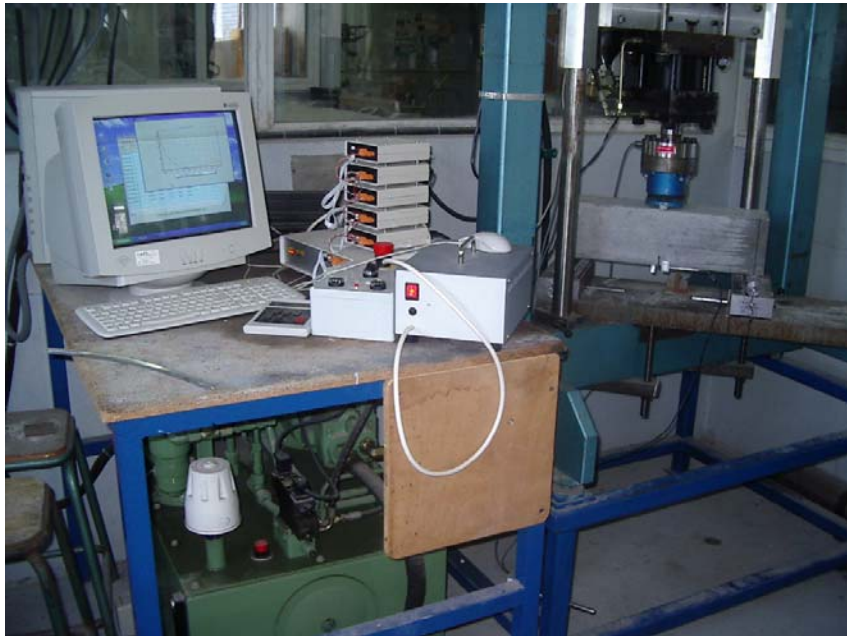
FigIV-7: Eléments du dispositif de flexion 03 points
