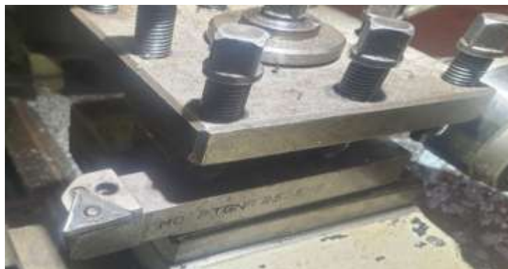
Fig III.6 Outil à charioter et dresse
