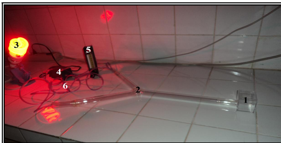
Figure 11 : Tube en forme de « Y » : Olfactomètre Bidirectionnel.
