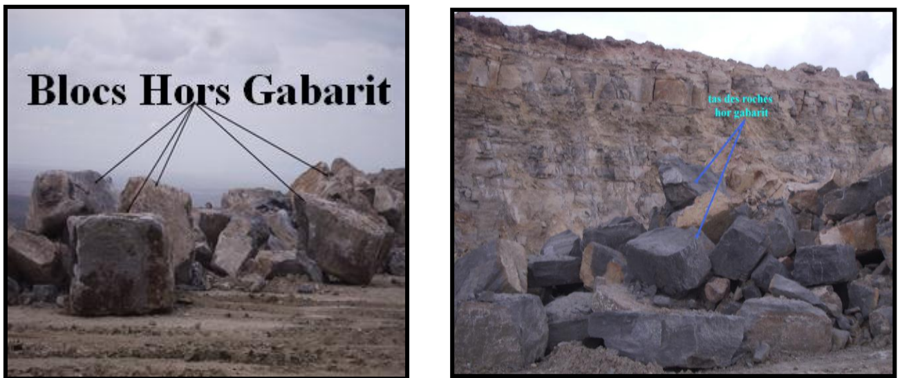
Fig. 3.3 Vue du tas de roche abattu avec des hors gabarits
