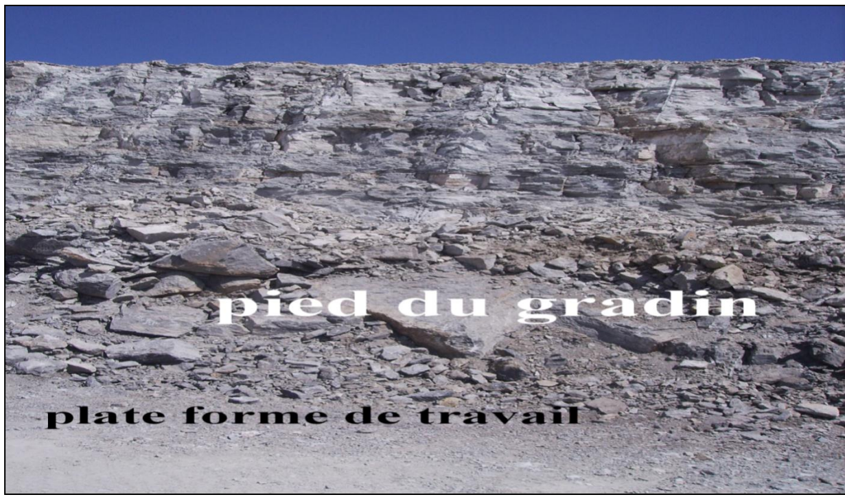
Fig.3.4 Vue du massif rocheux montrant un mauvais tir au niveau du pied du gradin
