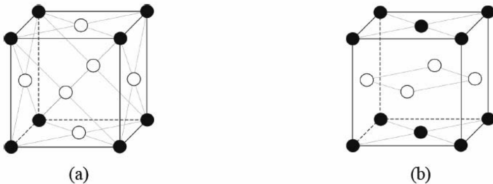
Figure III. 13 : Distribution des atomes de Fe et de Ni sur les sites d'un réseau fcc pour parfaite superstructure substitutionnelle atomique:
