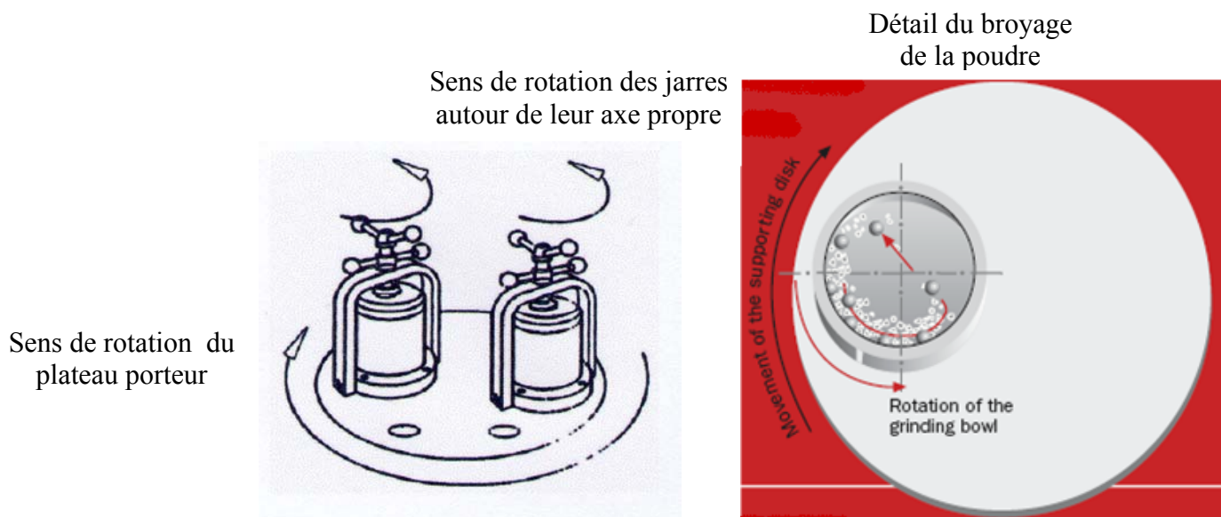
Figure II. 5 Schémas expliquant le fonctionnement du broyeur planétaire.
