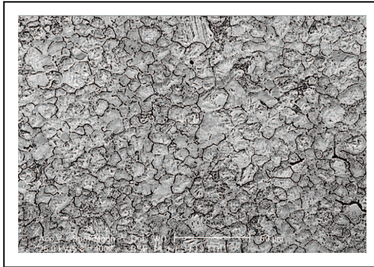
Figure 6: la structure austénitique d'un acier H11 [17].
