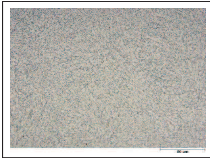
Figure 4: structure d'un acier AISI H11 à l'état recuit [12].
