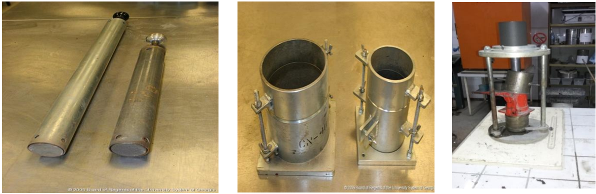
Figure 4.9 Dames, moule CBR et Proctor, Extracteur manuel pour essai de compactage
