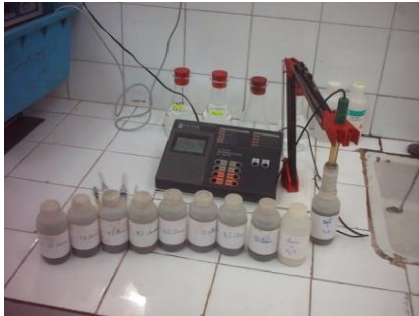
Figure 4.8 Mesure du pH (Méthode d'Eades et Grim)
