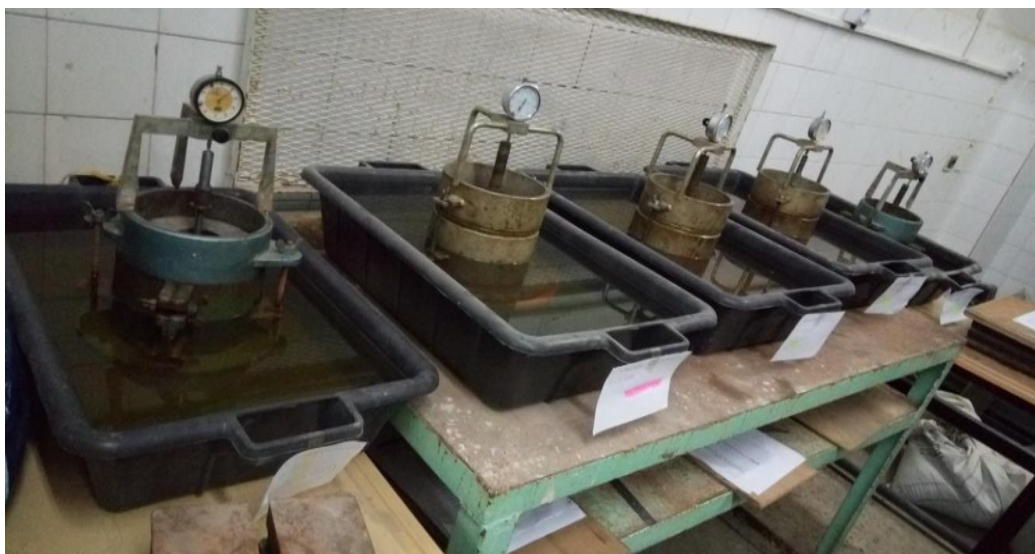
Figure 4.12 Cinq Systèmes de mesure de gonflement de sol en cours
