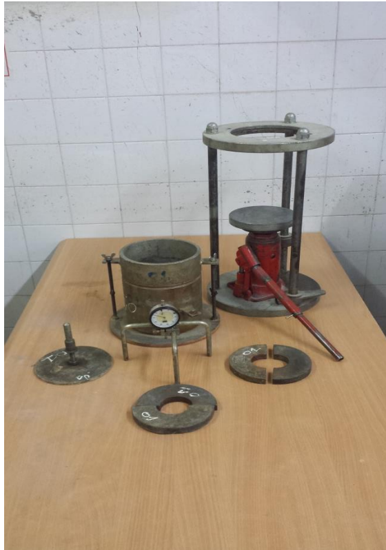
Figure 4.11 Outils pour l'essai de gonflement linéaire (moule CBR avec une base perforée, plaque de chargement, anneau de chargement fondu normalisé de type M&O
