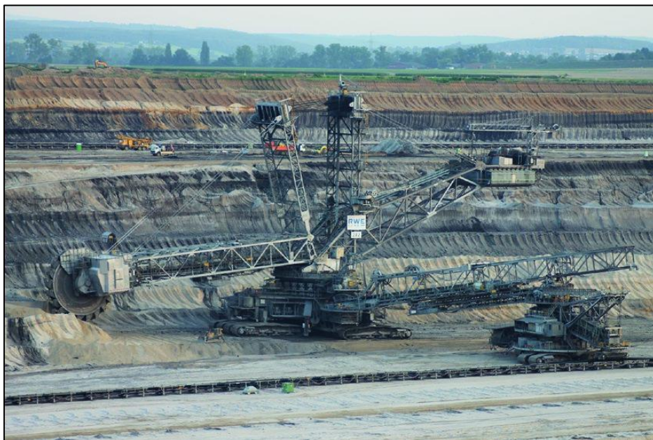
Fig.57 : Excavatrice à godets multiples (Drebenstedt & Singhal, 2013)
