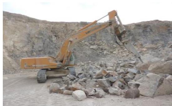
Fig.55 : Exemples des hors-gabarits dans une mine à ciel ouvert et processus de débitage secondaire
