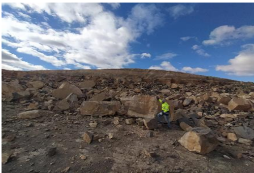
Fig.55 : Exemples des hors-gabarits dans une mine à ciel ouvert et processus de débitage secondaire
