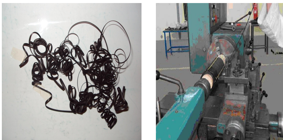
(a) (b) Figure 41: La forme finale du copeau (filament) à gauche en spirale (a). Le dégagement du copeau à la main à droite (b).
