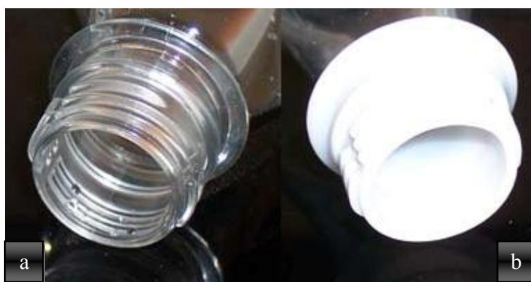
Figure 4: Une bouteille de polyester est transparente en (a). Exposé à la chaleur suivi d'un refroidissement lent, la bouteille deviendra translucide presque blanche opaque en (b).
