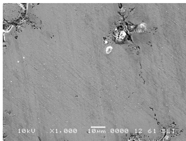
Figure III.13. Microstructure MEB de l'acier au manganèse allié à 0.10 % (Mo + Nb) à l'état traité
