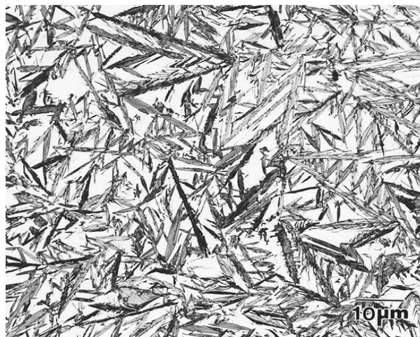
Figure I.26. Structure mixte, martensite + austénite résiduelle [33]
