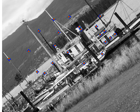
(c) Résultats : Les croix bleues sont les points choisis, les verts sont la projection en utilisant l'Homographie de la PSO, les rouges sont ceux de l'applet de Mikolajczyk
