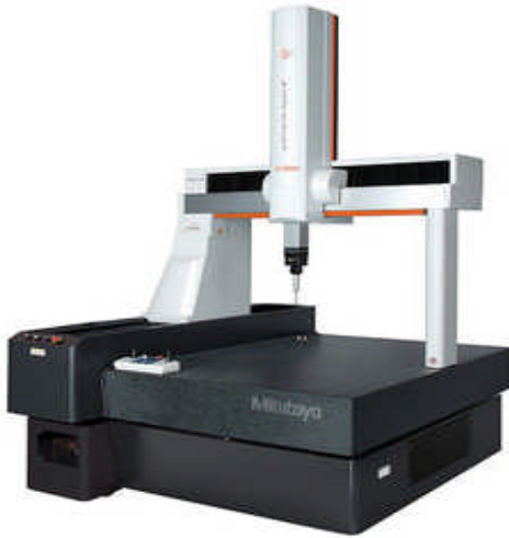
Fig.68 : Machine de mesure structure portique.
