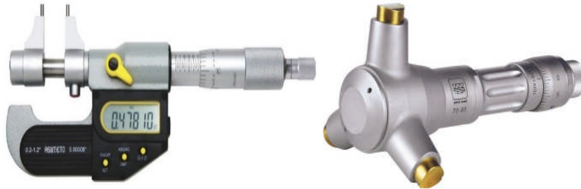
Fig.39 : Micromètre d'intérieur à becs et trois touches.
