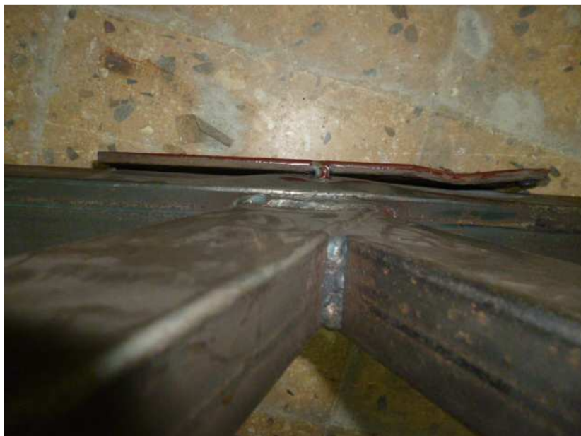
Fig.6.29* Plastification des parois de la membrure
