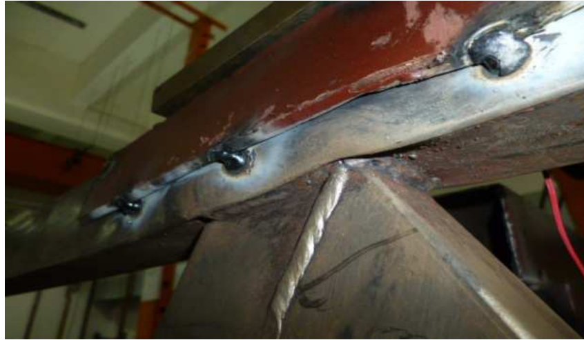
Fig.6.9 Plastification de la membrure supérieure au point d'application de la charge
