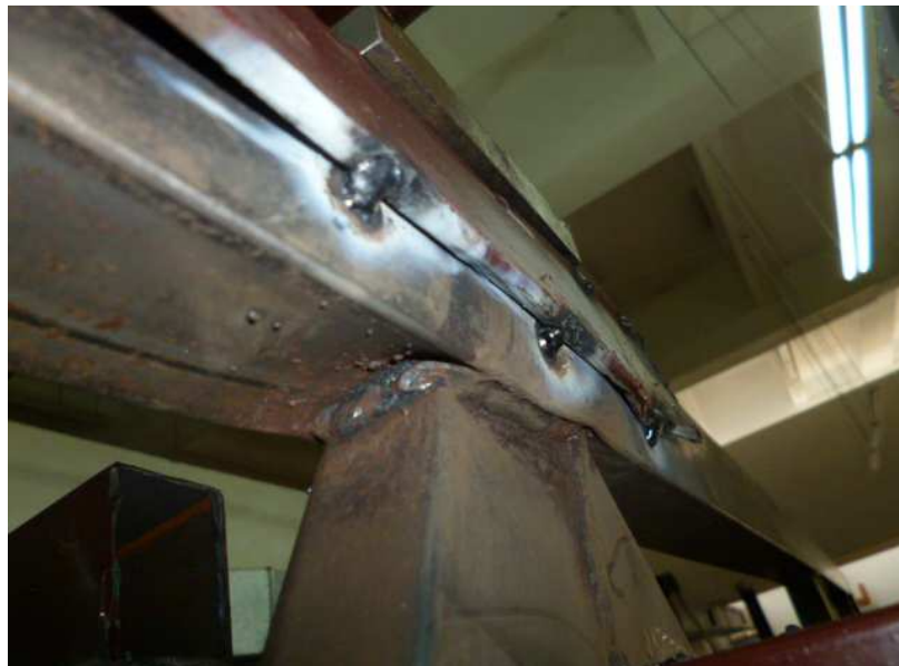
Fig.5.11 Plastification du Nœud 2
