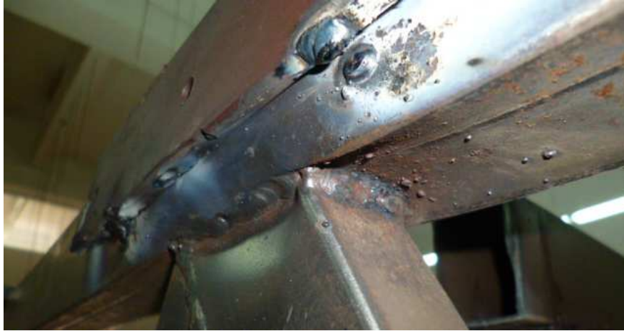
Fig.6.21 Déformation du nœud 2 (Expérimental)
