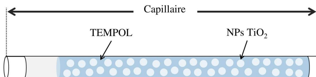
Figure III.15: Schéma d'un capillaire rempli par la suspension NPs TiO 2 / TEMPOL et scellé aux deux extrémités.
