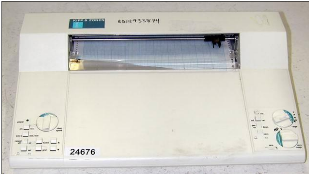
Figure 10 : Représentation de l'enregistreur graphique de la pression artérielle (BD11 enregistreur flatbed 1 voie).
