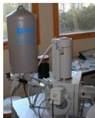
Figure II. 5 : Microscope électronique à balayage Philips XL 30 résolution 3nm
