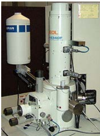
Figure II.4 : Microscope électronique à balayage JEOL JSM-6340F
