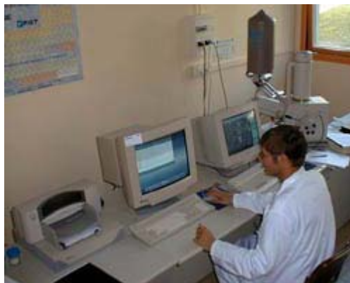
Figure II. 5 : Microscope électronique à balayage Philips XL 30 résolution 3nm
