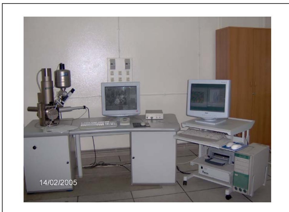
Figure (II.2) : Le Microscope électronique à balayage utilisé pour l'observation et l'analyse.
