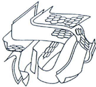
Figure A.4: Représentation schématique des microstructures du charbon actif [Bansa, 1988]
