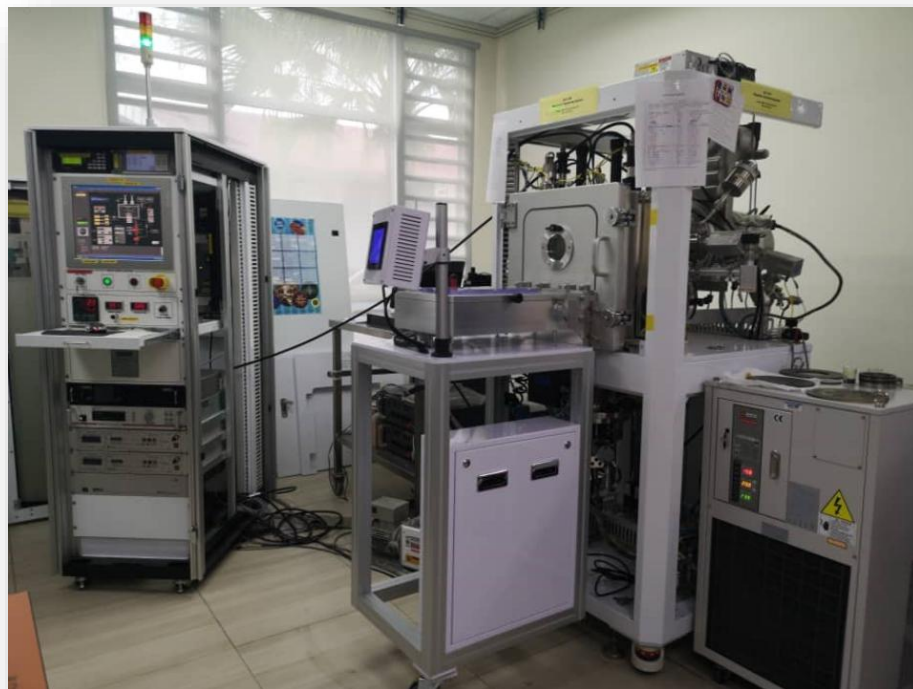
Figure II.1. Système de pulvérisation cathodique magnétron RF/DC SNTEK PSP 5004 (09SN70).
