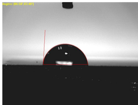
Figure III.22. Angle de contacts des revêtements A', B' et C'.
