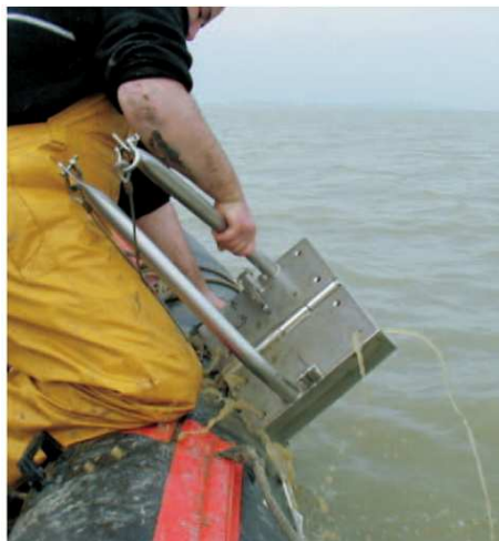
Figure 11. Prélèvement du sédiment avec la benne Van Veen.
